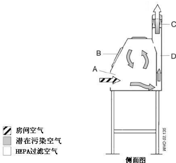
图6 I 级生物安全柜原理图
